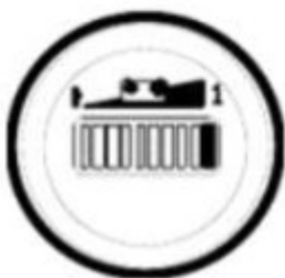
Батарея полностью заряжена
